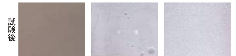
水系スーパーUVコートクリヤー-Si 異常なし 同等品(A社) 水性シリコンクリヤー クリヤーが劣化(白化・720h後) 同等品(B社) 水性シリコンクリヤー クリヤーが劣化(白化・720h後)
